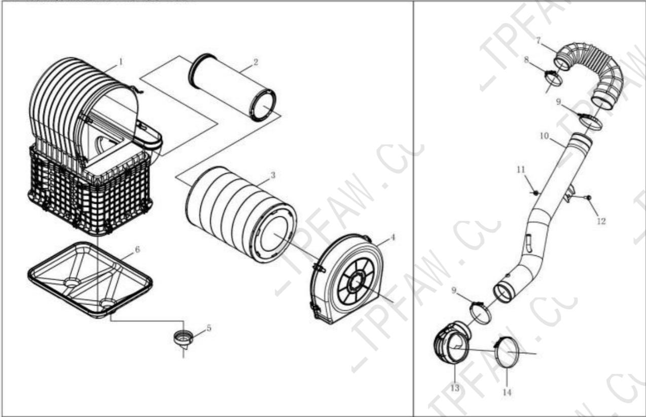
**空气滤清器总成（沙漠空滤）**
