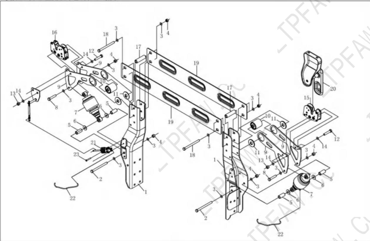
**驾驶室后悬置机构总成（气囊）**
